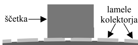
Slika 4.4: Drsenje ščetke po lamelah kolektorja
