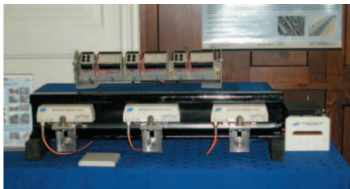
Sistem za zaznavanje vlaka TDR 14 z možnostjo smernega vklopa (foto: Altpro).
