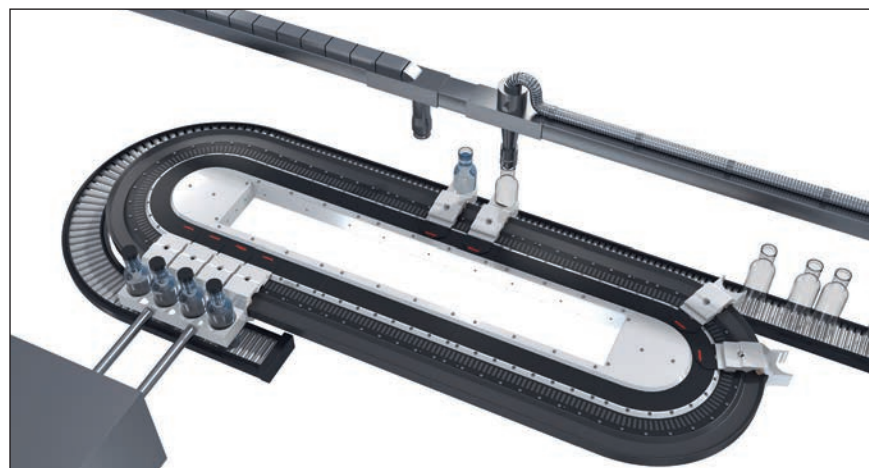
Slika 9. Krožni sistem XTS je idealen za sistem polnjenja steklenic, kjer se posamično obdeluje neprekinjen tok izdelkov
