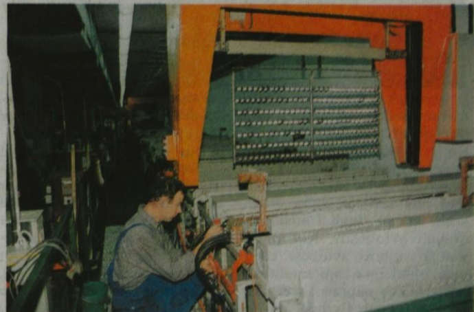
Z rekonstrukcijo linije bobnov in obešal so v Titanovi galvanici zaključili prvi dve fazi posodabljanja, sedaj pa jih čaka še uvedba ionskih izmenjevalcev. Tako bo celotni postopek galvanizacije tekel v povsem zaprtem krogu, kar bo pomenilo manjšo porabo vode in skoraj nobenih odpadnih voda.
