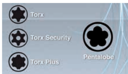
△ Vijaki z nestandardnimi vzorci zahtevajo nakup posebnega orodja, da lahko naprave odpremo. Slika: iFixit
