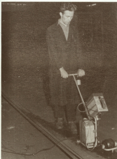
Preizkava debele pločevine z ultrazvokom leta 1962 (Arhiv Muzeja Jesenice)
