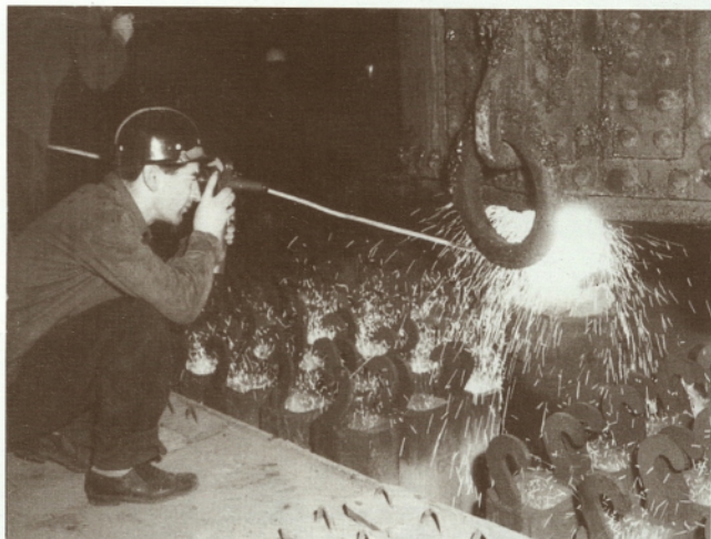
Merjenje temperature jekla v jeklarni z optičnim pirometrom leta 1964 (Arhiv Muzeja Jesenice)
