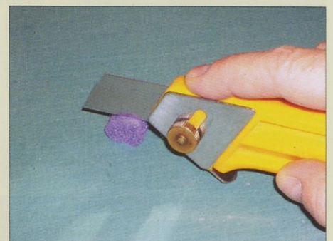
Slika 17. Obrezovanje zvitka z modelarskim nožem
