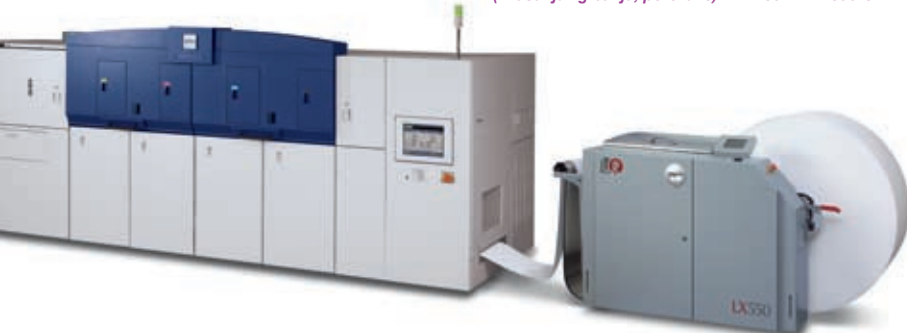
Sistem produkcijske linije Xerox 490 Lasermax z vhodnim modulom, LED-upodobitvenim kserografskim modulom, modulom fiksiranja tonerja flash-fusing, moduli dodelave (znašanja/zgibanja, porezave) in izhodnim modulom.
