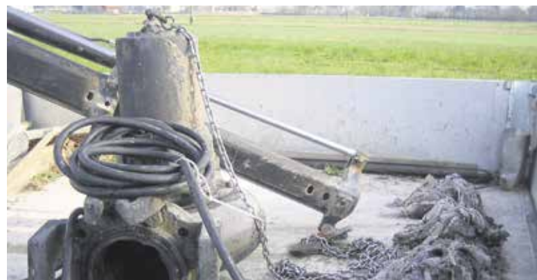
Eno izmed večjih težav v kanalizaciji predstavljajo vlažilni robčki in druge krpice, ki povzročajo zamašitev cevodov in okvaro črpalok.
