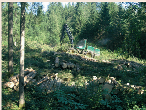
Slika 14. Pri sanaciji žarišč smrekovih lubadarjev v ustreznih sestojnih razmerah uporabljajo strojno sečnjo (september 2005, Kočevje) (foto: M. Jurc)
