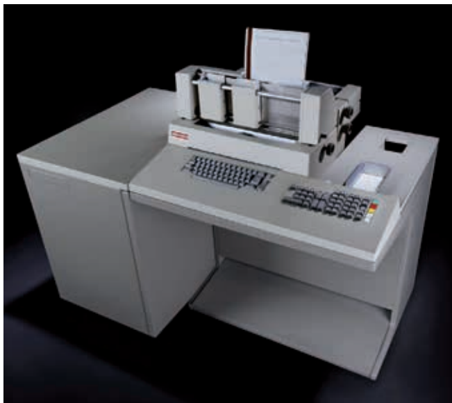
△ Nixdorf 820 je v času računalniških sob uvajal svojevrstno revolucijo. »Majhen« računalnik je bilo moč programirati za različne naloge.
