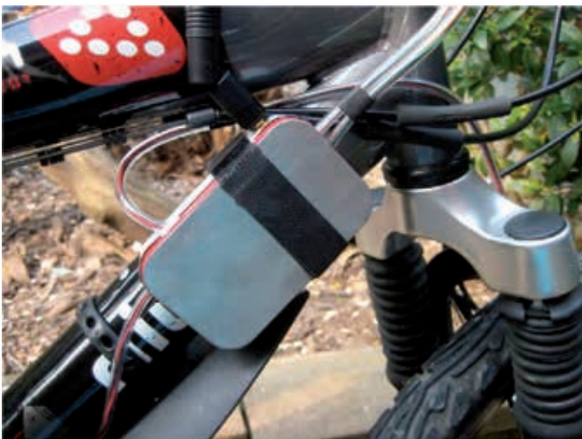
▽ Montaža krmilne enote kolesarskega merilnika na gorsko kolo.
