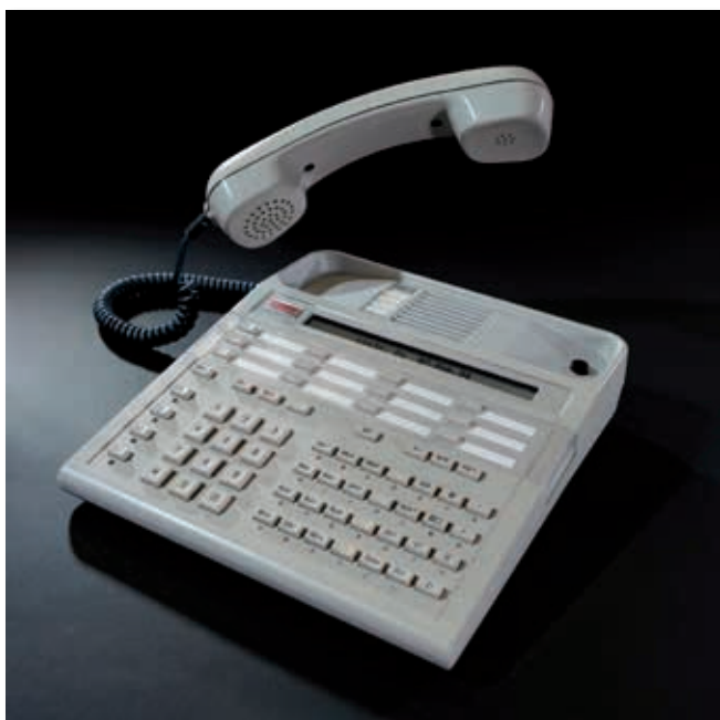
▽ Ena prvih telefonskih central ISDN na trgu je premogla od 15 do 25 funkcijskih tipk.
