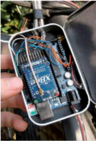
△ Krmilna enota kolesarskega merilnika razdalje in hitrosti na osnovi Arduina.
