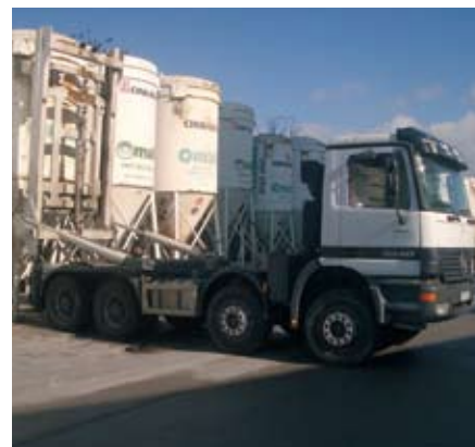
Tovornjak z nadgradnjo za prevoz mobilnih silosov
