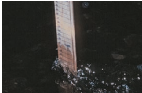
Merjenje ravni vode nad GRT je prej potekalo na sicer zelo preprost, a zaradi valovanja tudi nenatančen način – z lesenim šolskim ravnilom. Meritve sta izvajala dežurni nadzornik proge ali pooblaščen delavec.
