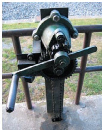
Signalna varnostna naprava oziroma kretniški blok kretniške postojanke II. na strani B postaje Središče. Bil je v uporabi do 24. februarja letos.
