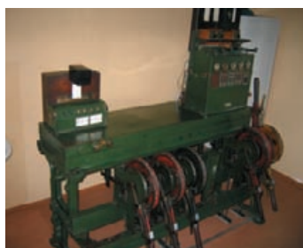
Mehanizem za zapiranje in odpiranje zapornic na strani B postaje Središče.
