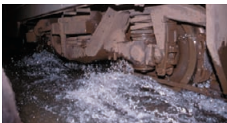
Voda lahko resno poškoduje naprave na lokomotivah in motornih vlakih
