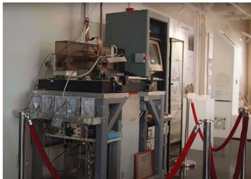
Slika 1. »Stroj Alpha«, prvi »pravi stroj«, je bil razvit na univerzi MIT za 3D-tiskanje z brizganjem
