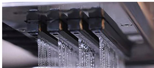
Slika 5. Tiskalna glava brizga vezivo na osnovi furfural alkohola
