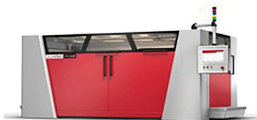
Slika 4. 3D-tiskalnik za peščene forme voxeljet VX 2000
