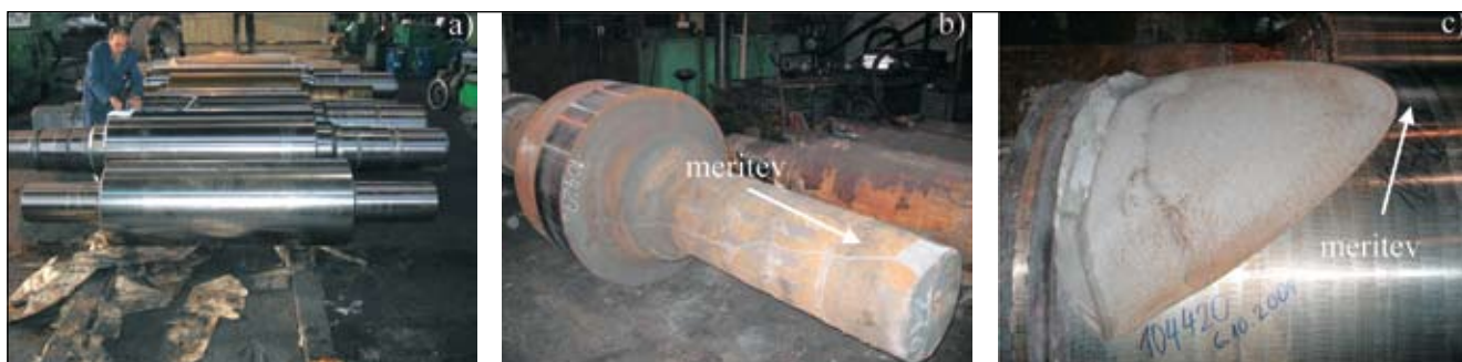
Slika 3. Valji za vroče valjanje po mehanski obdelavi (a), pokanje površine valja (b) in lom valja zaradi nepravilne toplotne obdelave (c)
