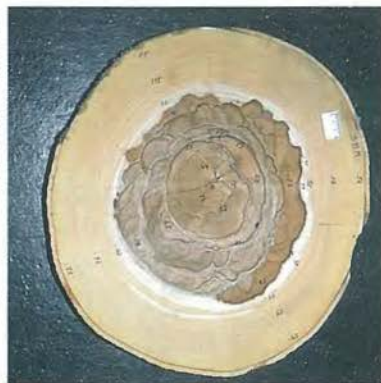
Slika 8: Bukev ( Fagus sylvatica L.) - tipično mozaično rdeče srce Figure 8: Beech ( Fagus sylvatica L.) - typical compound red heart
