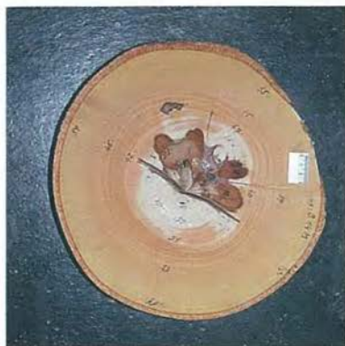
Slika 7: Bukev ( Fagus sylvatica L.) - rdeče srce se vselej razvije na mestu predhodno dehidrirane zreline (sušine)
