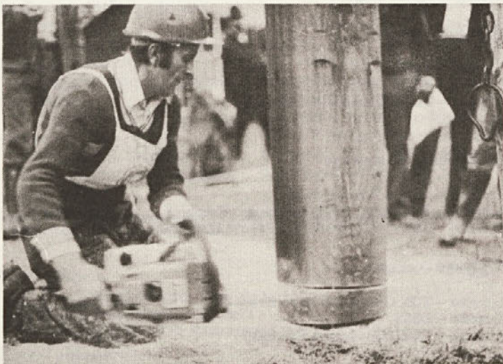
Od natančnega podžaganja je odvisno, če bo drevo padlo v namenjeno smer. Pri delu je Tone Hočevar iz TOK Gozdarstvo Novo mesto.
