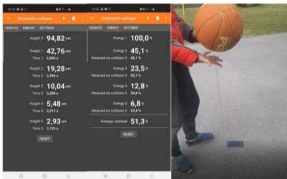
Slika 2: Merjenje izgube mehanske energije (Svit Krumpačnik).
