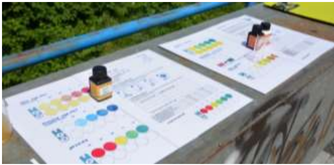
Slika 3: Kolorimetrična analiza nitratov. [8]
