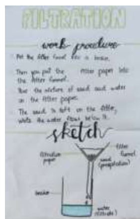
Slika 4: Ločevanje zmesi s filtracijo (4. skupina: zmes peska in vode)
