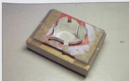
Slika 10. Dvodelna šablona za izrezovanje listov
