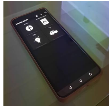
Slika 4: Mobilna aplikacija MQTT Dash z gumbi za vklop robotskega sesalca, pralnega stroja, luči in polnjenje električnega avta.
