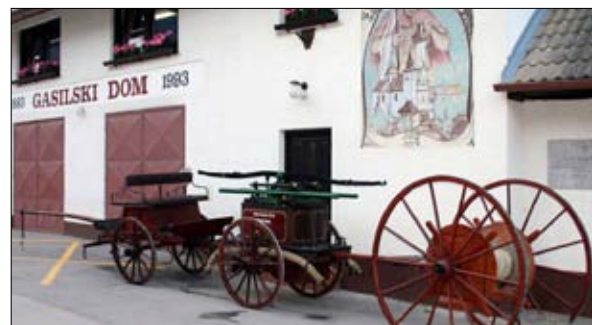
Dvoosna gasilska brizgalna na ročni pogon in konjsko vprego s priklopnim navijalcem za gasilske cevi, 1900
