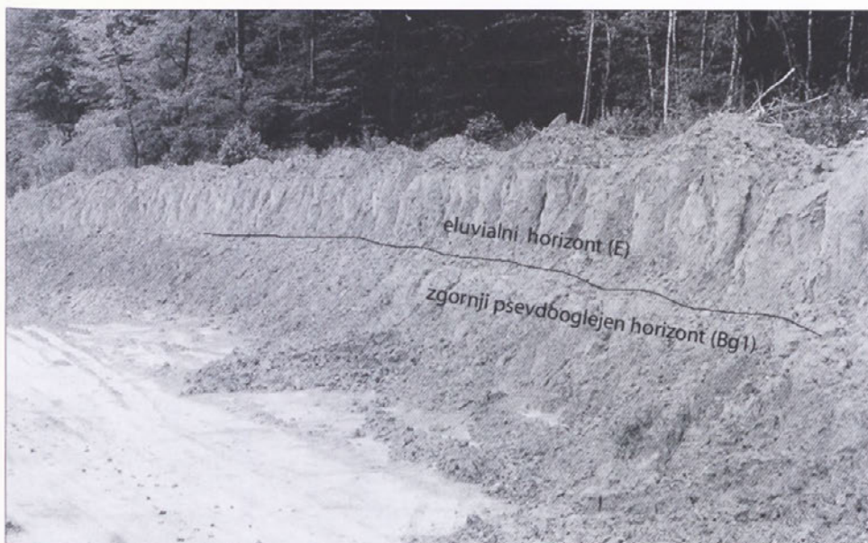
Slika 2: Zgornji del talnega profila na robu glinokopa. Pod horizontoma O (organski h.) in A (humozni h.), ki jih na sliki zaradi majhne debeline ne moremo izdvojiti, je debel izpran (eluvialen) horizont E, ki je značilen za lesivirana tla. Pod njim je prvi psevdoglejen horizont
