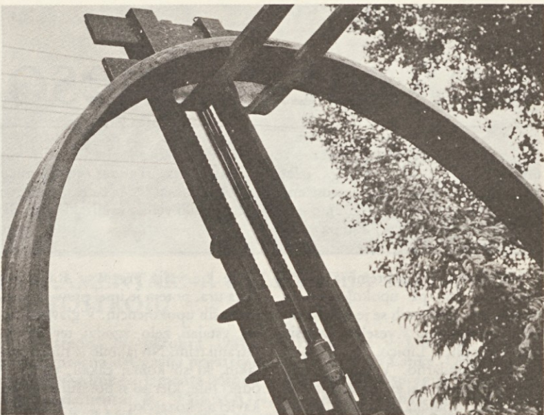
Tesnilni obroč izdelan po dokumentaciji Litostroja, vlit v pesek, premera Ø 4200 mm.
