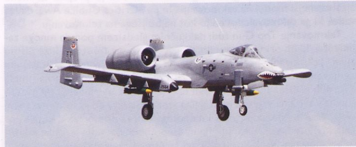
A-10 v nizkem preletu z izvlečenim podvozjem in spuščeni zakrilci. To je tekmovalna figura »Dirty Pass«, pri kateri mora tekmovalec pri minimalni hitrosti ohraniti smer in višino leta pri preletu pred sodniki.
