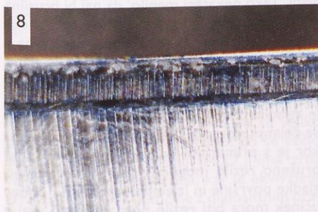
8 Japonski nož Ryusen po večmesečni uporabi. Rezilo ima dvojni V-lom, rob je lepo poliran in malenkostno poškodovan. Povečava je 250-kratna.
