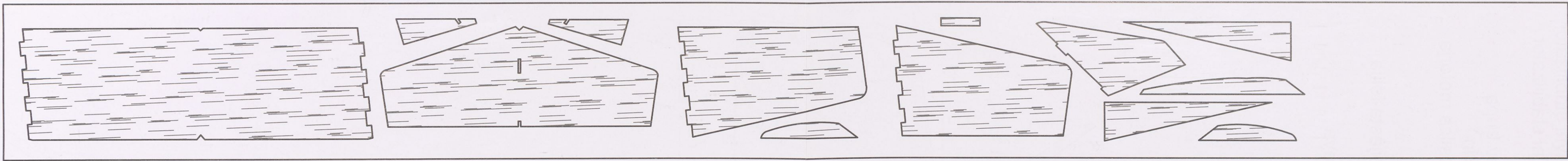
PRIKAZ RAZPOOREDITVE DELOV NA PLOŠČI BALZE DEBELINE 1,5 mm M 1 : 2
