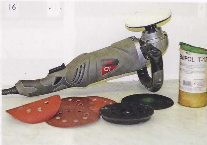
Kotni polirni stroj z nastavljenim številom vrtljajev in z različnimi nastavki za brušenje in poliranje
