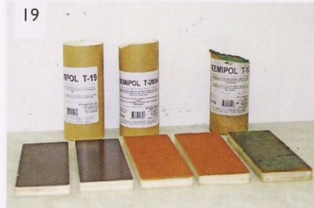
Paste in podlaga za ročno poliranje rezil. Pasta T 200/a se uporablja za predpoliranje, T 12 in T 19 pa sta namenjeni poliranju trdih jekel in kroma.
