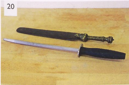
Palice za glajenje rezil. Spredaj je jeklena WMF, zadaj pa starinska gladilna palica.
