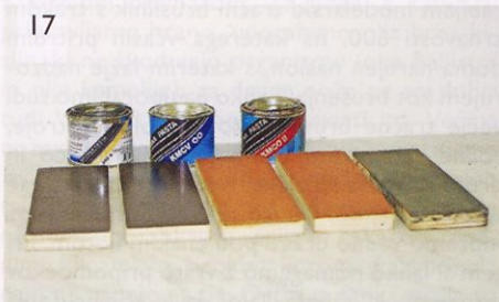
Brusilne paste, ki jih nanašamo na krpe, usnje, les ali steklo, so primerne za fino brušenje.
