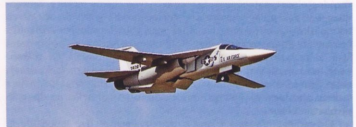
Maketa lovca bombnika FB-111 Aardvark. Model lahko med letom spreminja geometrijo kril. Na sliki so krila v položaju za počasno letenje oziroma v konfiguraciji za vzlet in pristane.
