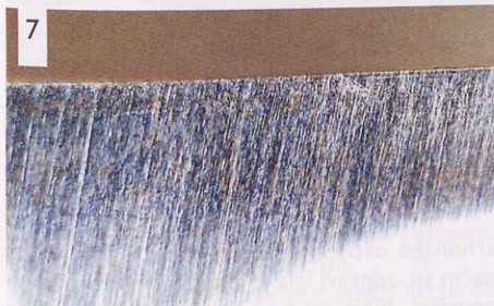
7 Isto rezilo, polirano s pasto T-12. Površina je še bolj gladka, igle pa ni več videti. Povečava je 250-kratna.
