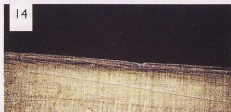
14 Na sliki kuhinjskega noža AMC so po 30 letih uporabe dobro vidne poškodbe. Nož potrebuje temeljito brušenje. Povečava je 80-kratna.
