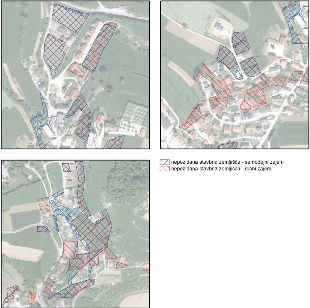
Slika 12: Detajlnjši izseki nepozidanih stavbnih zemljišč z rezultati samodejnega zajema in fotointerpretacije – testno območje Veliki Gaber.
