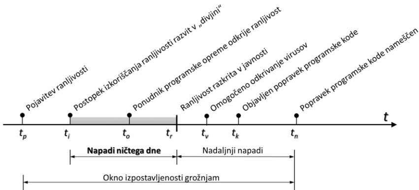
Slika 2.2. Okno izpostavljenosti ranljivega informacijskega sistema grožnjam (angl. Window of Exposure ). Najbolj kritično je obdobje od trenutka, ko napadalcu uspe razviti postopek izkoriščanja ranljivosti, do trenutka javne objave obstoja ranljivosti (Bilge & Dumitras, 2012, str. 833).
