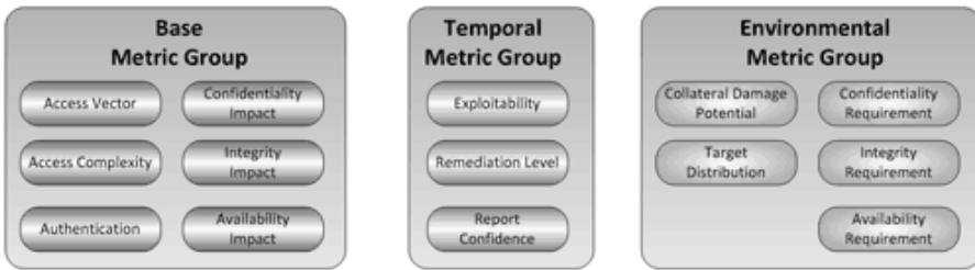
Slika 3.2. Shema atributov po standardu CVSSv2. Atributi so razdeljeni v tri skupine: osnovni ( Base ), časovni ( Temporal ) in okoljski ( Environmental ) (Mell, Scarfone, & Romanosky, 2007).
