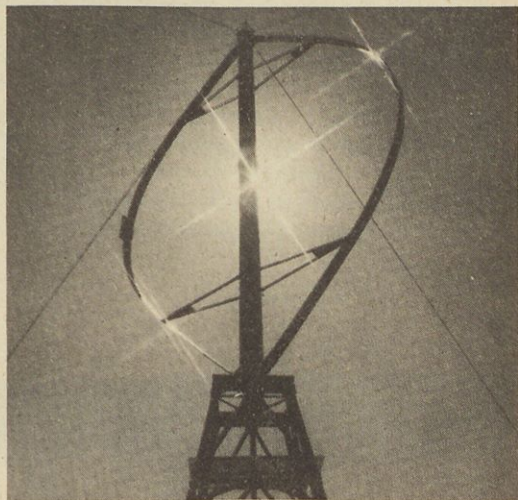
Slika 2. Poskusna vetrnica Darrieus, ki so jo zgradili v ZDA, poganja črpalko, ki zmore na minuto 1500 litrov vode za namakanje
