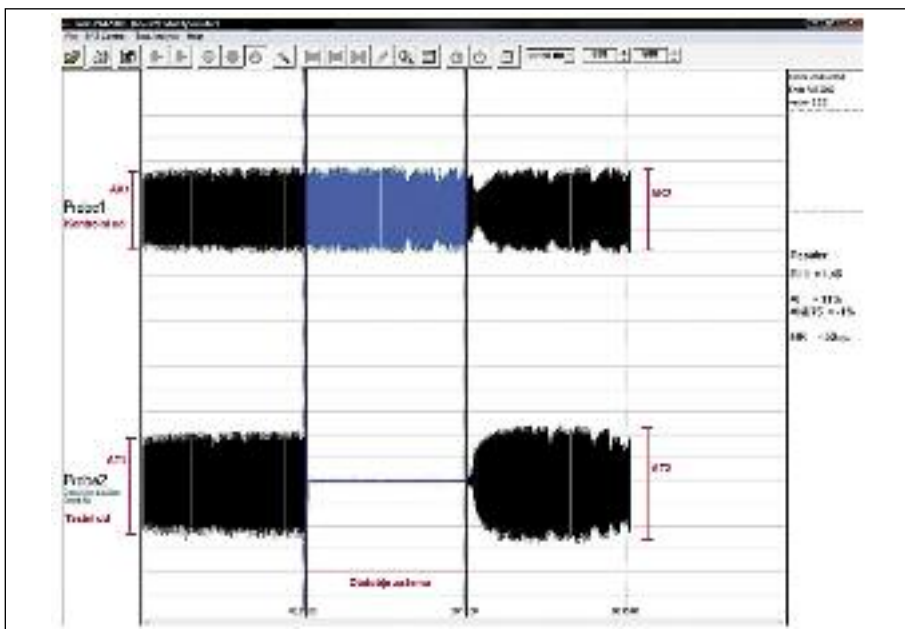
Slika 2b. Zaslona z rezultati meritve s periferno arterijsko tonometrijo. V sredini zaslona so prikazane krivulje meritve. Rezultati so prikazani na desni strani, kjer je izračunan indeks reaktivne hipertenzije. AT2 – pulzna amplituda na testnem udu po zažemu, AT1 – povprečna pulzna amplituda na testnem udu pred zažemom, AK2 in AK1 – smiselno enako za kontrolni ud.
