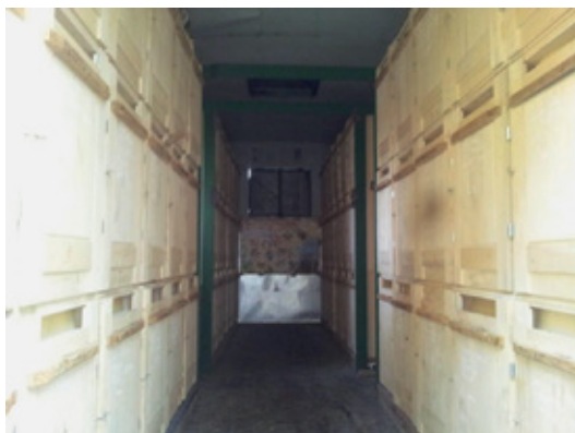
Notranjost prevozne enote pozimi, ko so loputice za zračenje odprte
