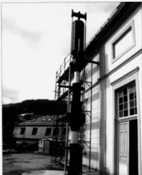
Restavrirana črpalka in pogonski stroj Kley
