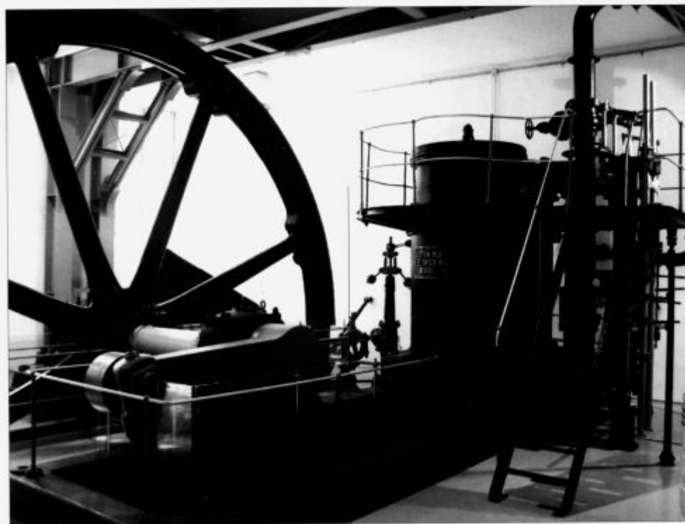
Restavrirana črpalka in pogonski stroj Kley
