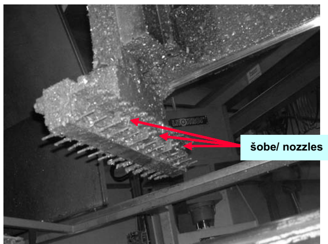
Sl. 6. Šobe za razprševanje olja v kalupu Fig. 6. Nozzles for oil spraying the mould
