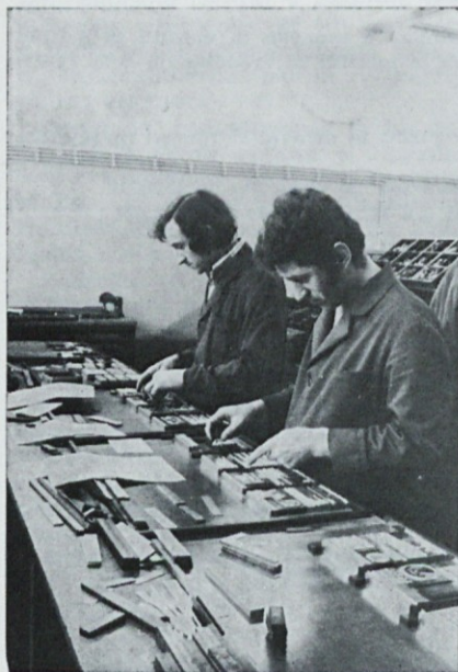
Ko je svinčeni stavek narejen, ga ročni stavec oblikuje v strani in pripravi za tisk
