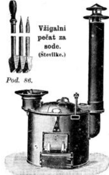
Podoba 84. Stroj za parafiniranje sodov »Seitz«.
