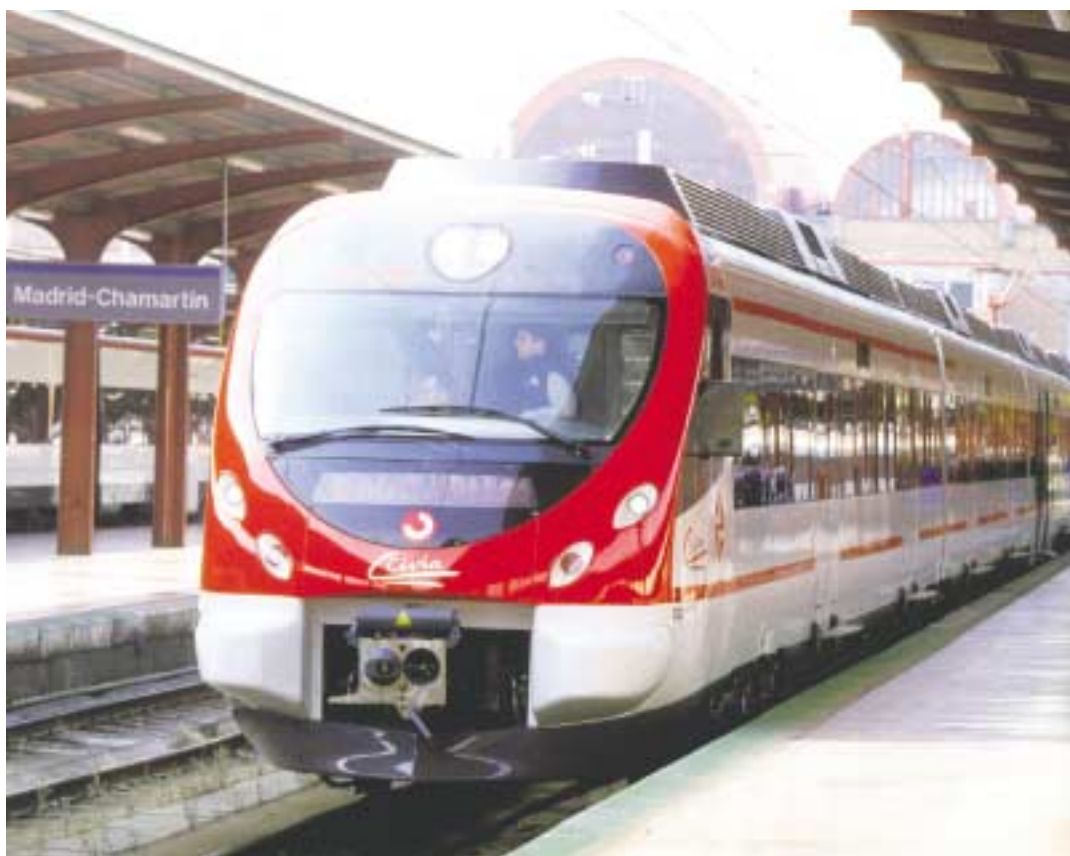
Španske državne železnice (Renfe) v predmsetnem prometu Madrida uvajajo nove modularne elektromotorne garniture Civia.
