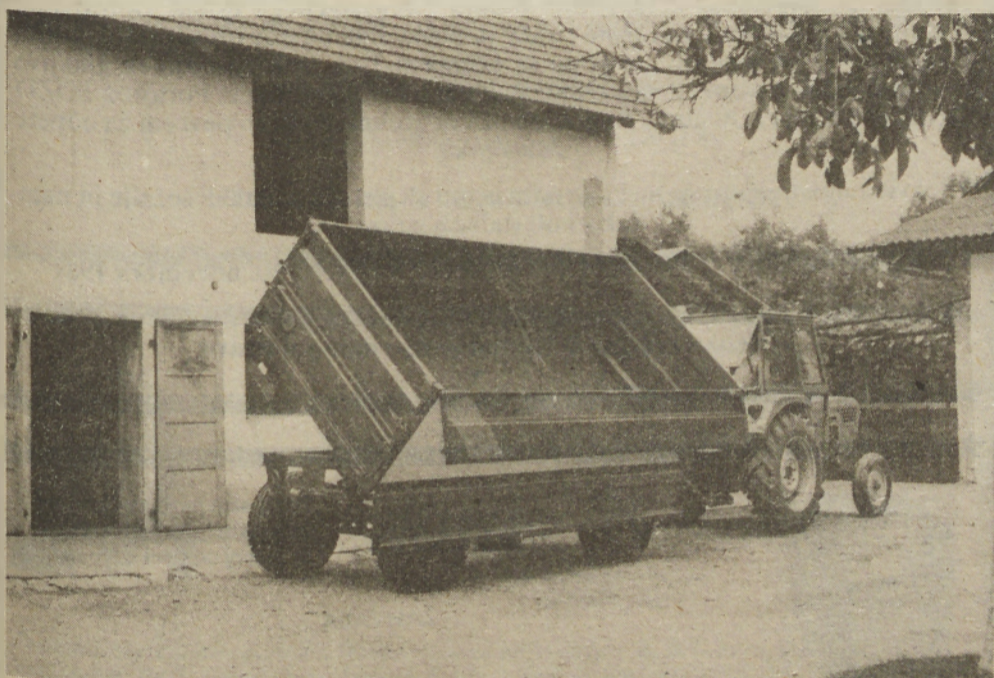
Dvoosna kiper prikolica za prevoz pridelkov v rinfuzi nosilnosti 5 ton TEHNOSTROJ 620. 2. Namenjena je predvsem individualnim kmetijskim proizvajalcem. Nov način labirintskega tesnenja stranic je zmanjšal izgube zrnja med prevozom. Široke pnevmatike dovoljujejo transport tudi po razmočenih njivah. Z vgrajenimi kvalitetnimi materiali je nova prikolica vzdržljivejša in enostavna za uporabo.
