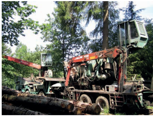
» Slika 7. Mobilni sistem za odstranjevanje lubja med delovanjem v gozdu
