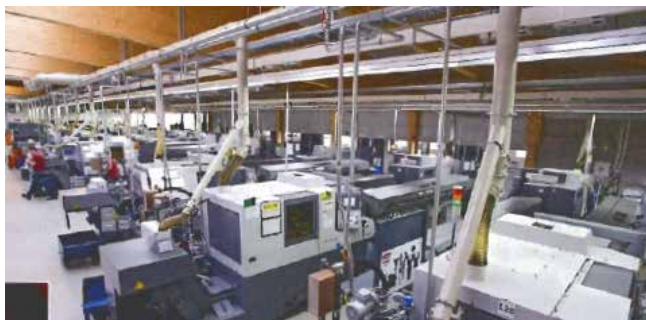
Impresiven pogled na proizvodnjo podjetja Loga Präzisionsteile oHG: natančno 30 vzdolžnih stružnih avtomatov Citizen Machinery Europe GmbH obdeluje visokozahtevne komponente.
