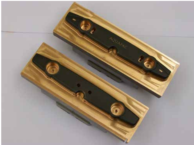
» Isti obdelovalni stroj obdeluje tudi orodja za elektroerozijo, s katerimi se na elektroerozijskem stroju končno obdelajo orodja za Aquapac.
