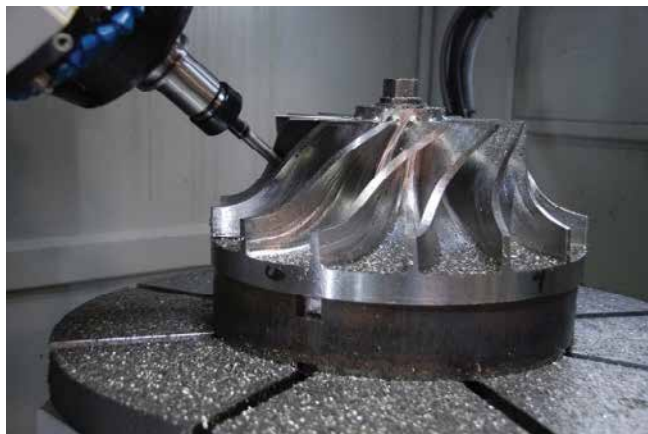
» Primer simultane petosne obdelave na obdelovalnem centru Hurco VMX42SR
