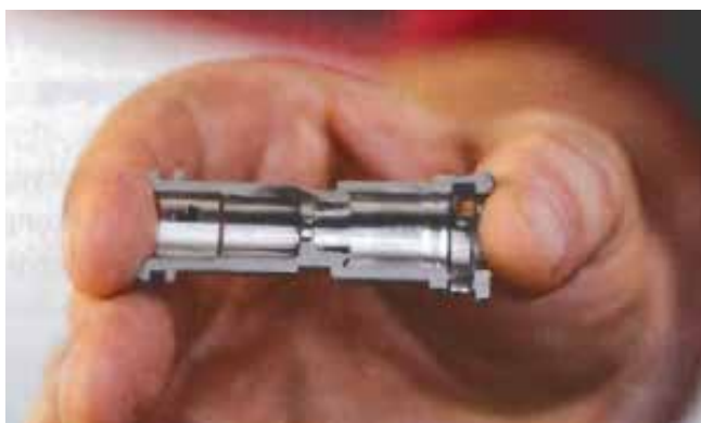
» Logina specialnost so taki struženci z zahtevnimi notranjimi konturami (na sliki je viden prerez). S Citizenovimi zmogljivimi avtomati jih izdelujejo v najvišji kakovosti in v treh izmenah.
