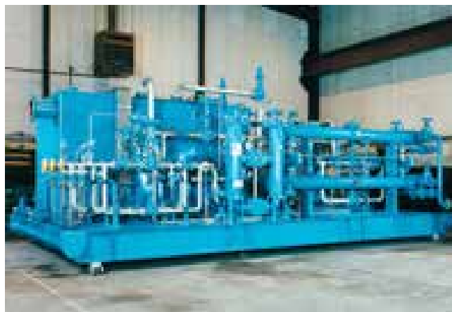
» Izmenjevalnik toplote za hlajenje mazalnega olja. Slika: Funke
