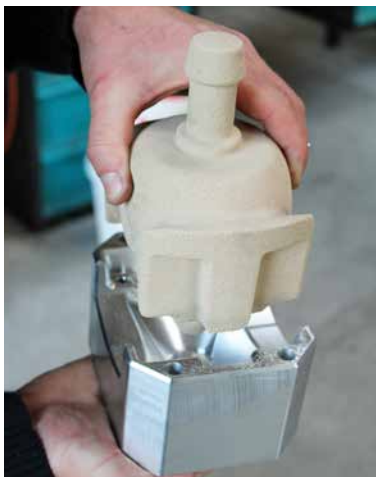
» Aluminijasto rezkano ležišče za pečeno jedro, ki ga robotsko prijemalo vloži v formo (foto: Klaus Vollrath)
