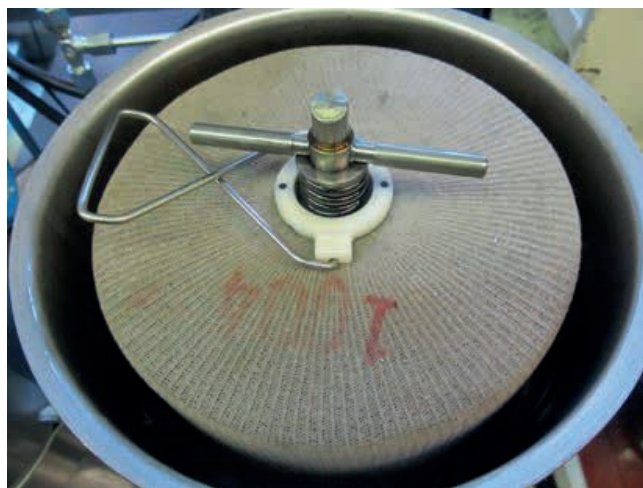
» Slika 3: Filtrirni vložek Harvard-Hidex ( \phi 180 \times 480 \text{ H} )
