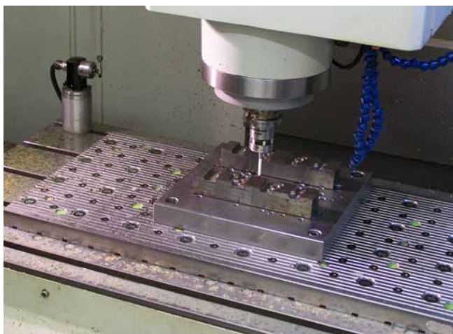
» Merilna glava na vreteno nastavi orodje Aquapac za grobo in srednje fino obdelavo.
