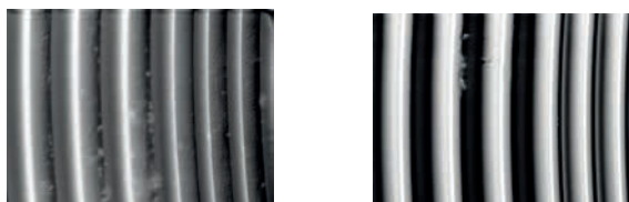
» Učinki dvolomnosti in mikroskopski pogled (spodnja slika) kažejo razlike v kakovosti pri primerjavi standardnega brizganja (vsakič levo) in HiQ Shapinga (vsakič desno).
