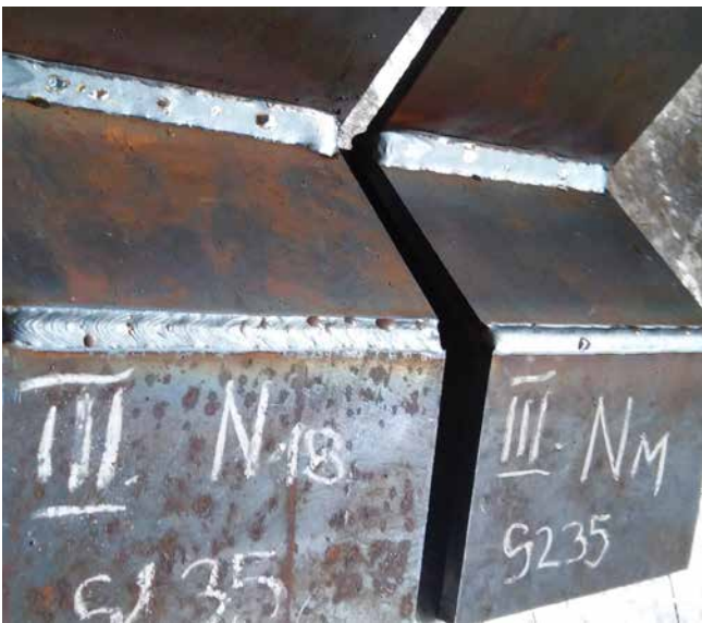
» Slika 1: Varjenje pločevine S235 debeline 8 mm, MIG/MAG, zaščitni plin Ar82%CO 2 (levo) in sodobna mešanica (desno)
