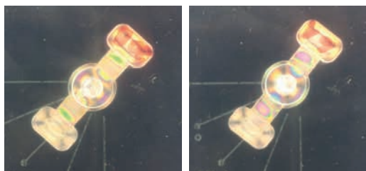
» Lastne napetosti in usmerjenosti, prikazane s polarizacijskim filtrom
