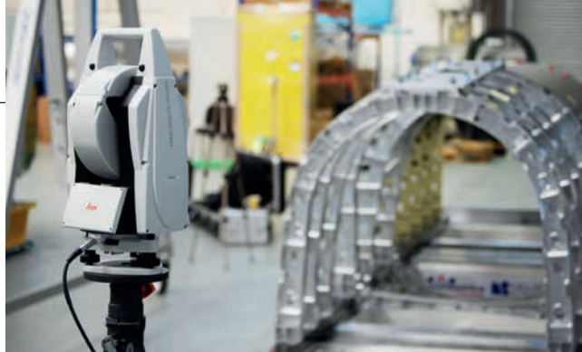
» Slika3: S senzorjem Leica B-Probe za sledilec Leica Absolute Tracker AT402 je mogoče izmeriti celotno zgornjo šasijo iz enega položaja sledilca.
