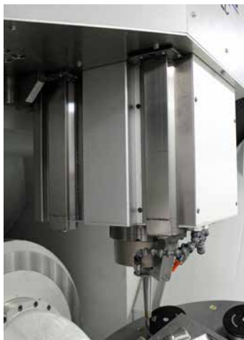
» Masivna os Z kvadratnega prereza pri konceptu Quadroguide ima namesto običajnih dveh kar štiri vodila, nameščena v vogale za večjo togost. (Foto: Klaus Vollrath)
