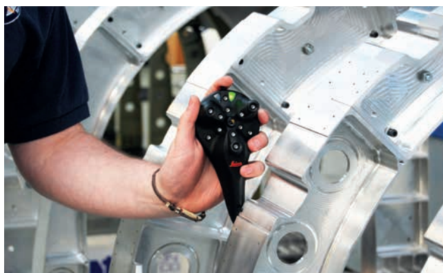
» Slika 1: Leica B-Probe uporablja tehnologijo PowerLock, ki avtomatsko zaklene laserski žarek na sondo.
