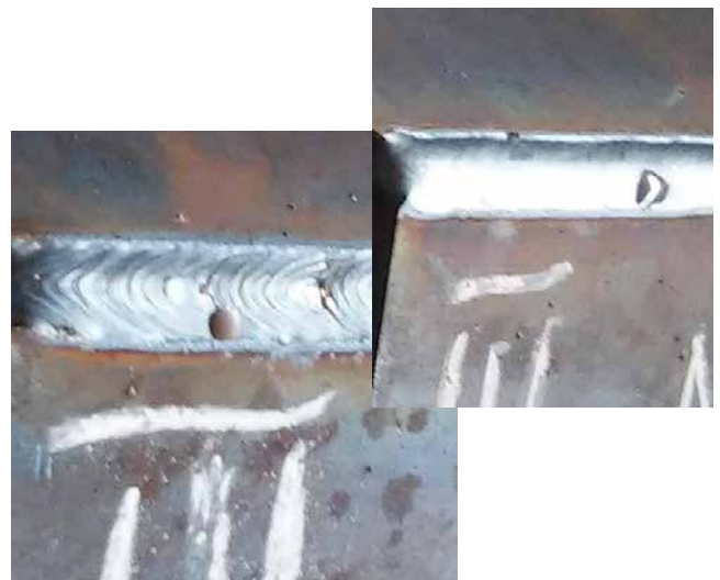
» Slika 2: Povečana površina vara. Levo: varjeno z M21 Ar82%CO 2 , desno: sodobna mešanica.
