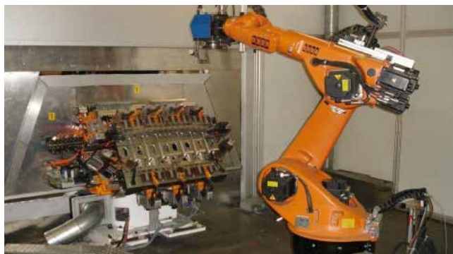
» Slika 8: Lasersko skenirno varjenje pokrova prtljažnika VW Pasata
