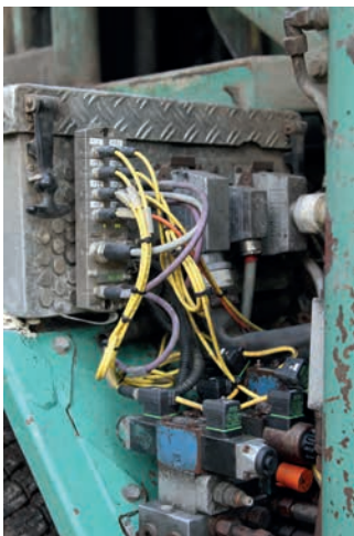
» Slika 1. Nameščen sistem MKV Metal blizu hidravličnega krmilja z dvojnimi sponkami za ventil
