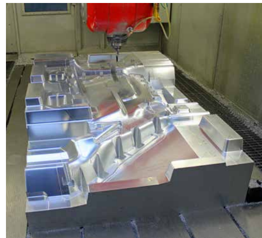
» Centri za obdelavo običajnih materialov za izdelavo modelov pri rezkanju jeklenih modelov velikega formata trčijo ob svoje omejitve. (Foto: Klaus Vollrath)
