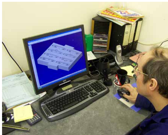
» Proces se začne s CAD-modelom, kot je prikazan model za Aquapac, iz katerega se izdelava program za obdelavo.
