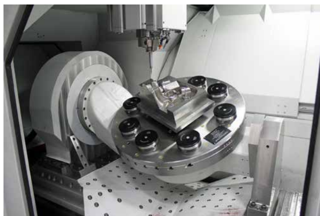
» Pogled v delovni prostor novega stroja Rödgers RXH 1200 DSH. Vrtljiva miza ima vpenjalni sistem z ničelno točko. (Foto: Klaus Vollrath)
