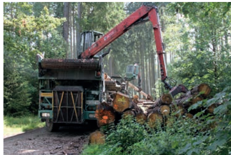
» Slika 5. Mobilni sistem za odstranjevanje lubja med delovanjem
