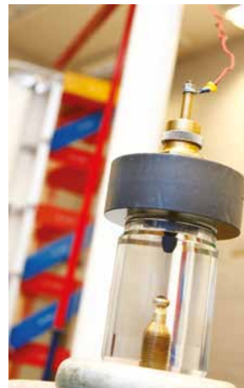
» Slika 2. Impulzni prebojni test transformatorskega olja
