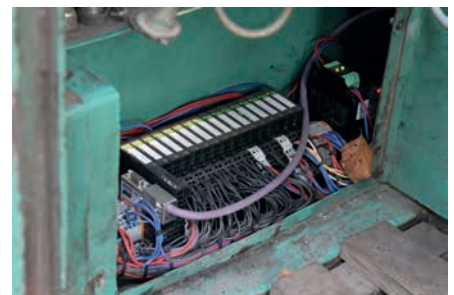
» Slika 2. Sistem Cube20S v elektro omari kabine stroja
