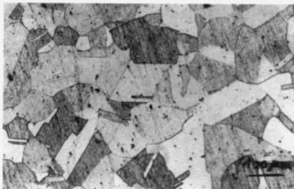
Figure 1: Microstructure after solution annealing Slika 1: Mikrostruktura po topilnem žarjenju
