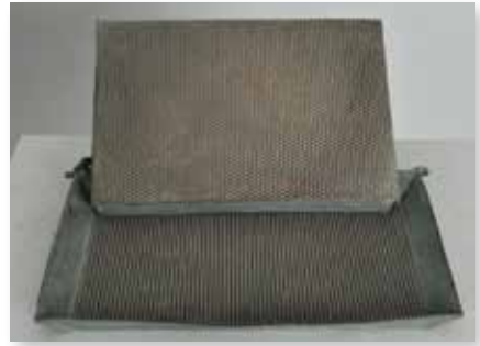
Priprava za vlivanje satnic (v katalogu za leto 1898, št. artikla 150).
