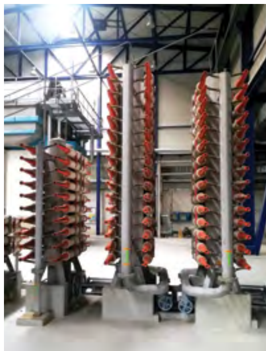
Slika 2.21: Vrtnični cevni čistilci – klinerji
