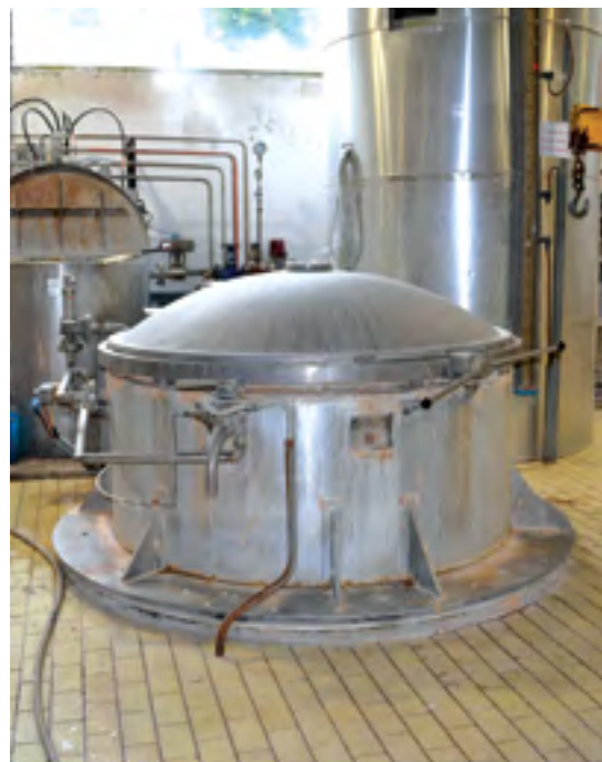
Slika 2.28: Kuhalnik, v katerega postavimo koš, napolnjen z bombažem
