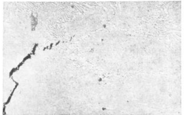
Slika 6 Potek razpoke v delu prirobnice z nespremenjeno strukturo. Jedkano ( \text{CuSO}_4 + \text{HCl} + \text{H}_2\text{O} ); pov. 200 \times
