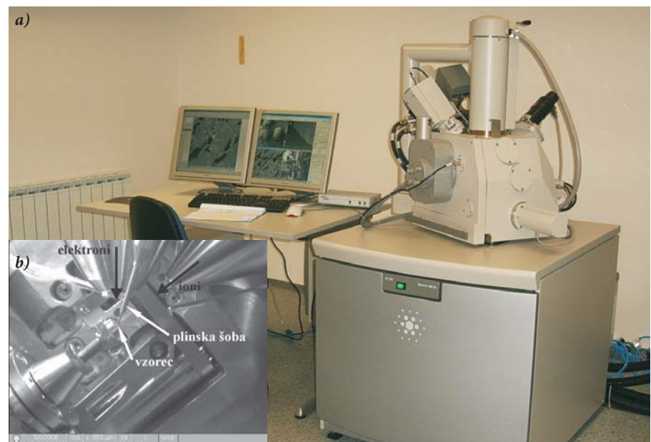
Slika 2: a) Naprava z dvojnimi elektronskim curkom Quanta 3D, FEI Company, instalirana v Univerzitetnem centru za elektronsko mikroskopijo Fakultete za strojništvo Univerze v Mariboru, b) notranjost komore
