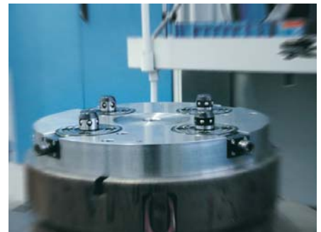
Halderjeva rešitev vpenjanja s sistemom ničelne točke pri izdelavi ozobljenja na gredi
