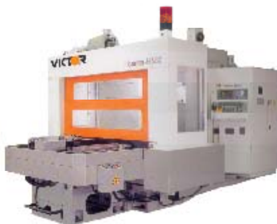
Horizontalni obdelovalni centri Victor: 16 palarni od 500, 600 in 1000 mm.
