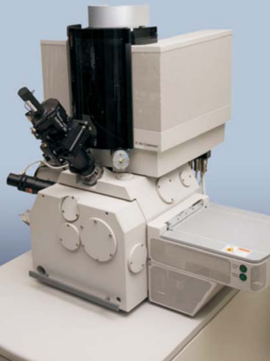
Slika 1: Mikroskop z dvojnimi ionskim in elektronskim curkom Helios 400 S
