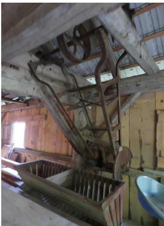
Slika 314: Del mehanizma opuščene žage iz 1920-ih let pri mlinu v Starih Žagah – tehnična dediščina, ki kljub dobremu stanju žal ni več v funkciji.
