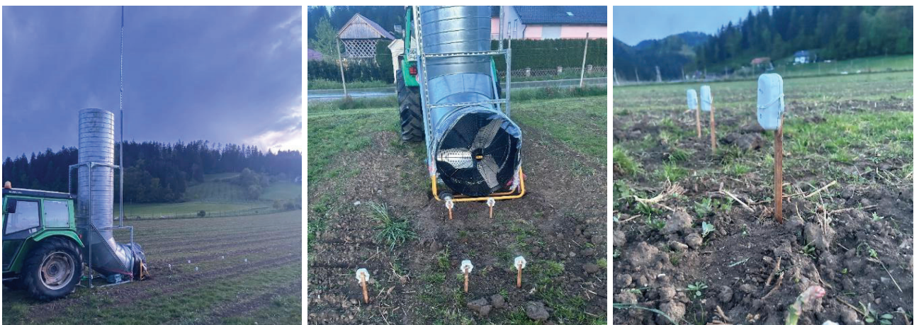
Slika 7: Postavitev priključka in senzorjev v nasadu špargljev med izvajanjem praktičnega preizkusa
