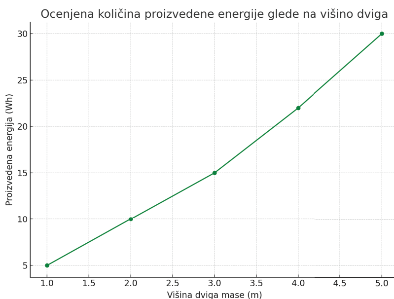
Slika 30: Ocenjena količina proizvedene energije glede na višino dviga
