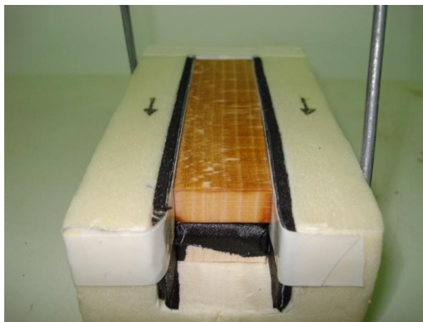
Slika 21 Priprava preizkušanca v postopku konvekcijskega sušenja lesa v adaptivnih pogojih.
