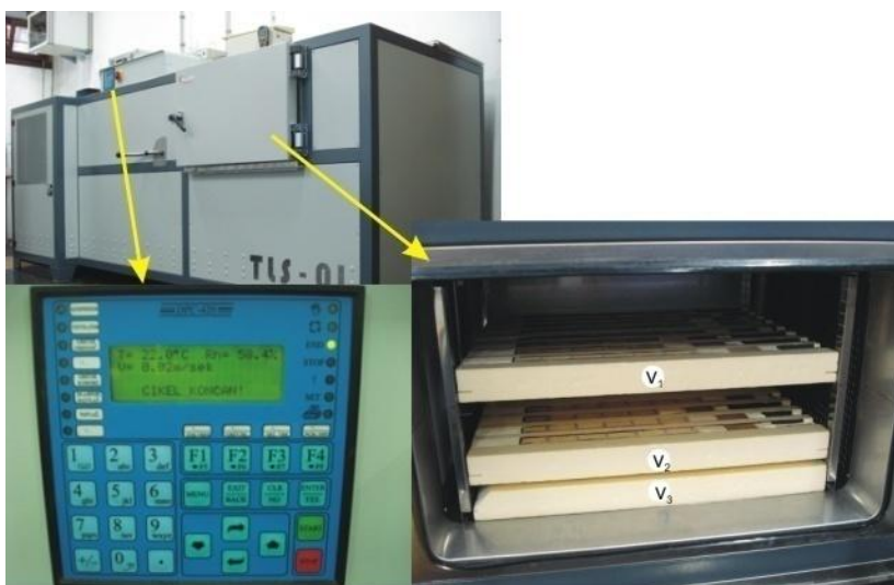
Slika 22 Konvekcijski sušilni kanal TLS-01 (zg. levo) s PLC krmilnikom (sp. levo) in z eksperimentalno komoro (sp. desno).
