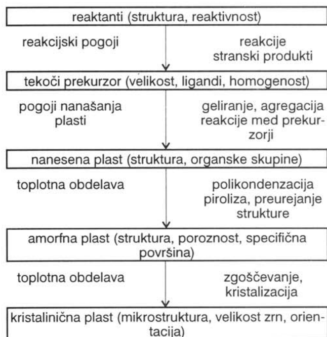
Slika 5: Shema sinteze FTP iz raztopin prikazuje spremljivke (levo), materiale in njihove lastnosti (v okvirčkih) in procese ali reakcije, ki potekajo v posameznih stopnjah (desno) /9/
