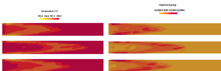
Slika 3: Temperaturno polje na treh različnih ravninah vzdolž sušilnega prostora levo in vlažnostno polje na treh različnih ravninah vzdolž sušilnega prostora desno.
