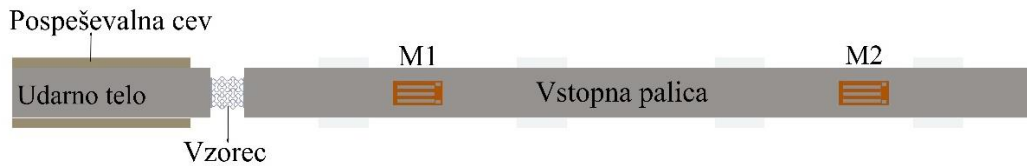
Slika 1: Shema sestave DIHB preizkuševališča.
