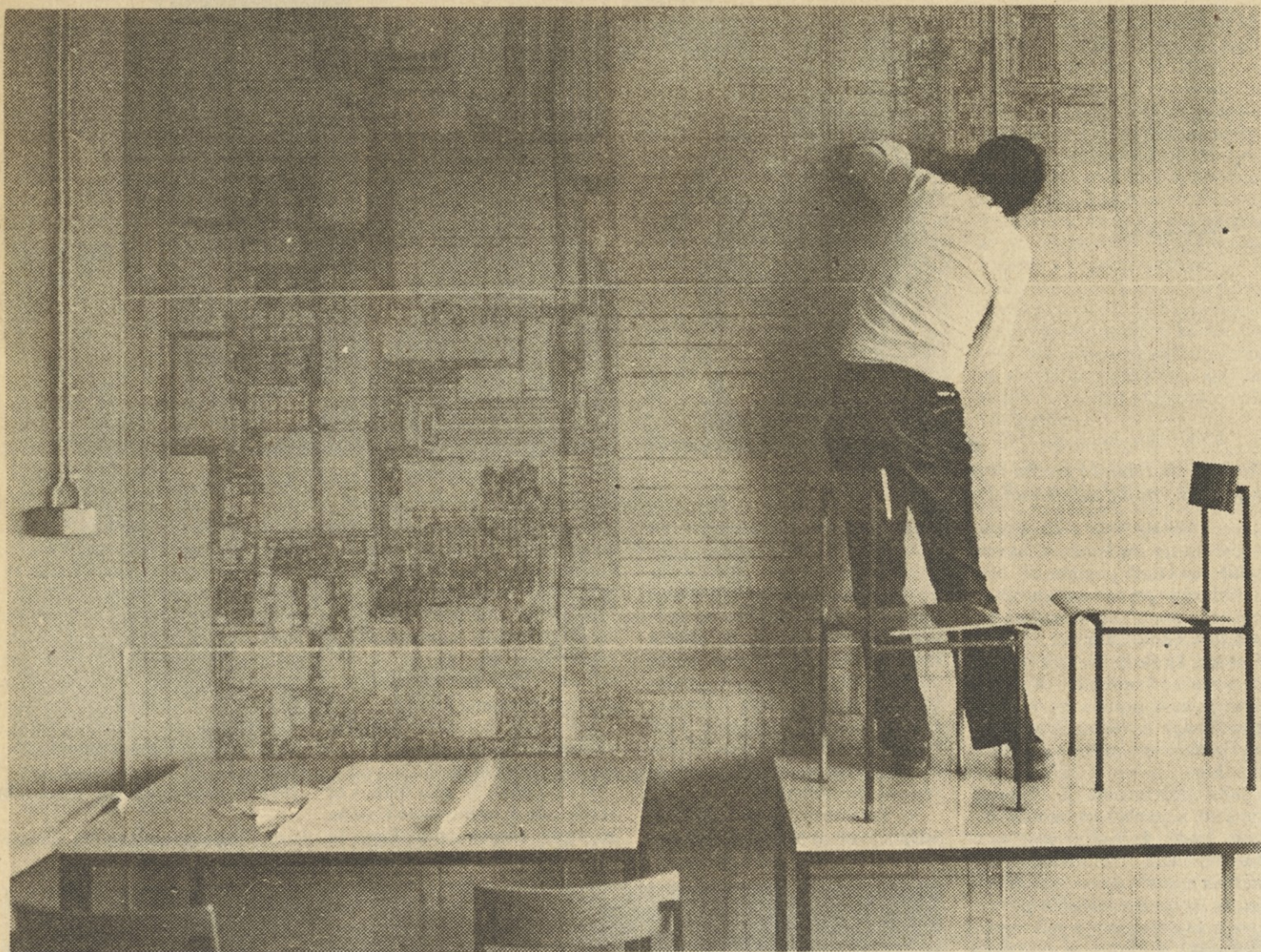
Na sliki vidimo načrt za monolitno integrirano vezje EMZ 1206, namenjeno za serijo novih Iskrinih telefonskih central sistema 2000. Načrt vezja je velik 4 x 3,5 metra. Po tem načrtu izdelajo v Mikroelektroniki sedemstotisočkrat manjšo rezino ali „čip“, to je integrirano vezje.
