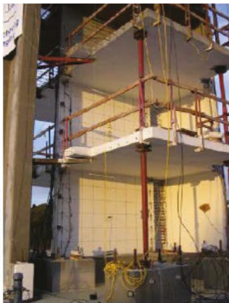
Slika 4 • Konzolna armiranobetonska stena, preizkušena na potresni mizi na UCSD.
