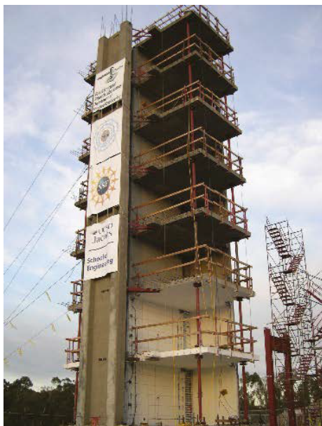
Slika 4 • Konzolna armiranobetonska stena, preizkušena na potresni mizi na UCSD.
