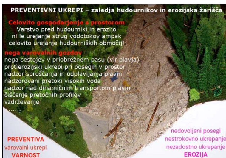
Slika 2: Hudourniški erozijski procesi (globinska in bočna erozija, transport plavin) se lahko – tako kot je prikazano na zgornjem modelu na levem bregu struge – brez ustreznega ukrepanja močno povečajo. S pravilno razporejenimi ustalitvenimi in zaplavnimi objekti lahko v veliki meri nadziramo intenzivnost erozijskih procesov.
