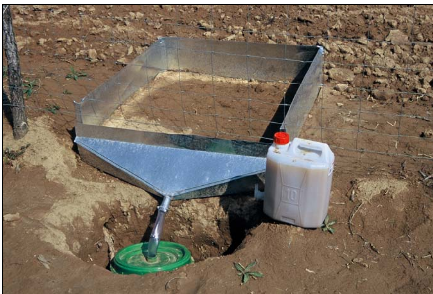
Slika 1: Erozijsko polje na goli prsti v oljčniku in gradivo ujeta v lovilno posodo v tednu med 7. 4. in 13. 4. 2005 (fotografija: Matija Zorn).
