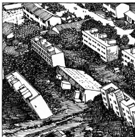
Slika 1: Risba kaže, kako pomemben je vpliv lokalnih geoloških razmer na seizmološke učinke. V stanovanjski soseski, zgrajeni na tleh iz rahlih zemljin, so se zgradbe v pasu delovanja toka podtalne vode porušile; dobesedno so se v zemljino, napito z vodo, pogrezale. Druge hiše nedaleč stran so ostale nepoškodovane (Levy in Salvadori 2002, 101).
