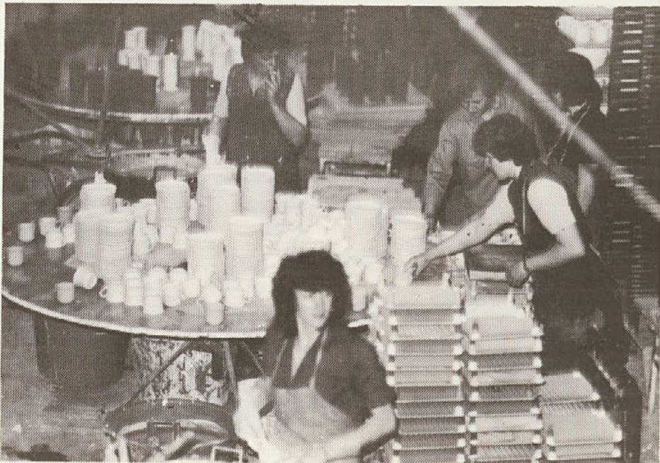
Glaziranje izdelkov z umakanjem – zahtevno in natančno delo
