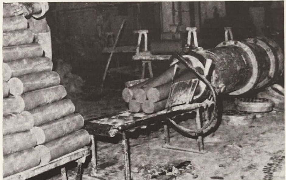
Vakuum gnetilec predela gmoto in jo oblikuje v ustrezne gmotne valje
